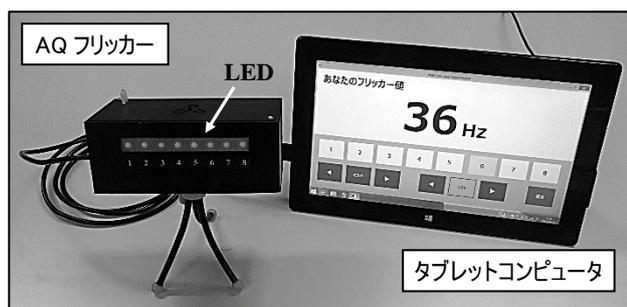
図 1 開発したフリッカー検査装置 (AQ フリッカー)
