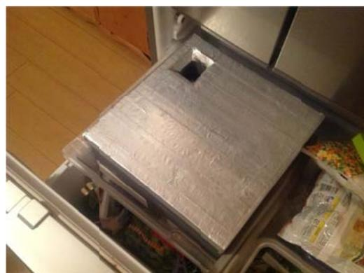
図 6 撮影モジュールを冷凍庫に収納する様子
