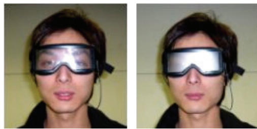
(a)透過時 (b)遮蔽時 図1 液晶シャッターゴーグルによる視界の遮蔽
